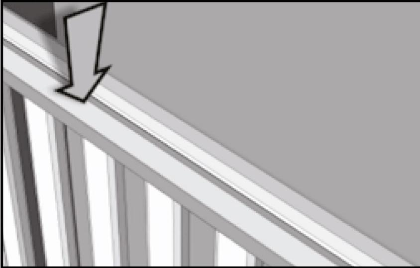
Monter le rail de guidage supérieur. Le centrer sur la traverse haute du portail\*.
