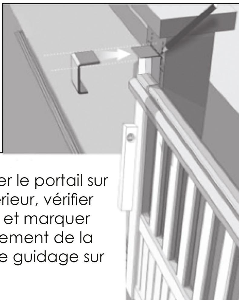
Positionner le portail sur le rail inférieur, vérifier l'aplomb et marquer l'emplacement de la platine de guidage sur le pilier.
