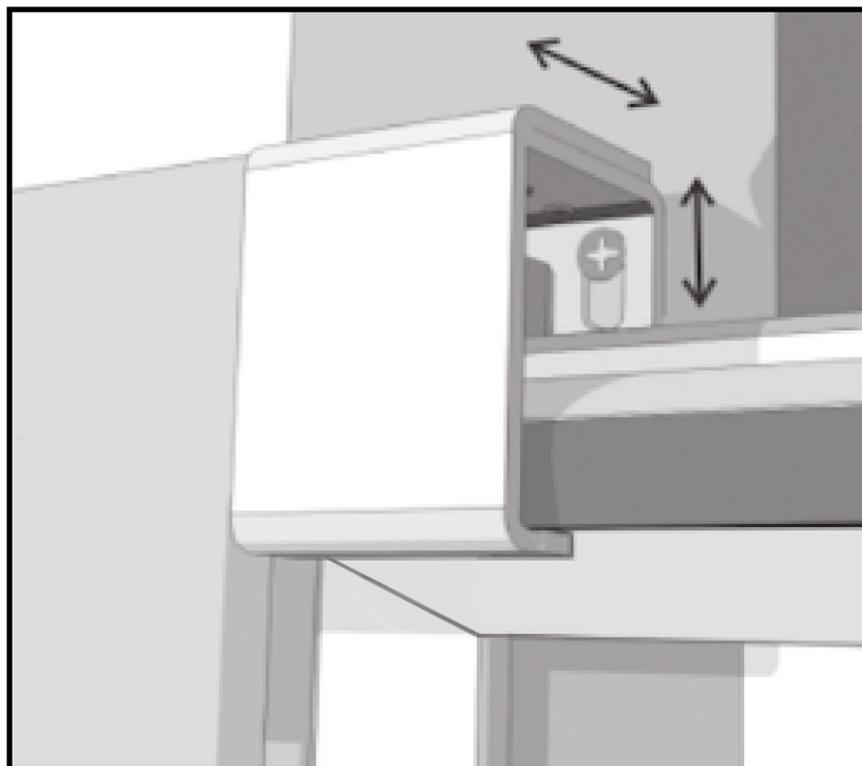
Si nécessaire, régler la hauteur et la profondeur de la platine de guidage pour optimiser le fonctionnement du portail.
