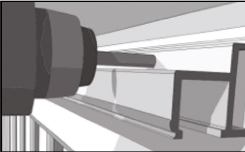
Fixer le rail avec des vis auto-foreuses, utilisant les pré-perçages\*.
