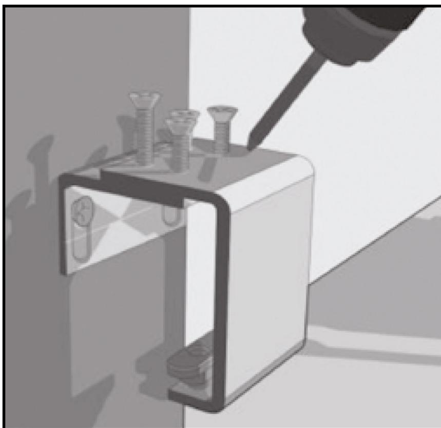
Fixer la platine de guidage complète sur le pilier avec le patin de guidage.
