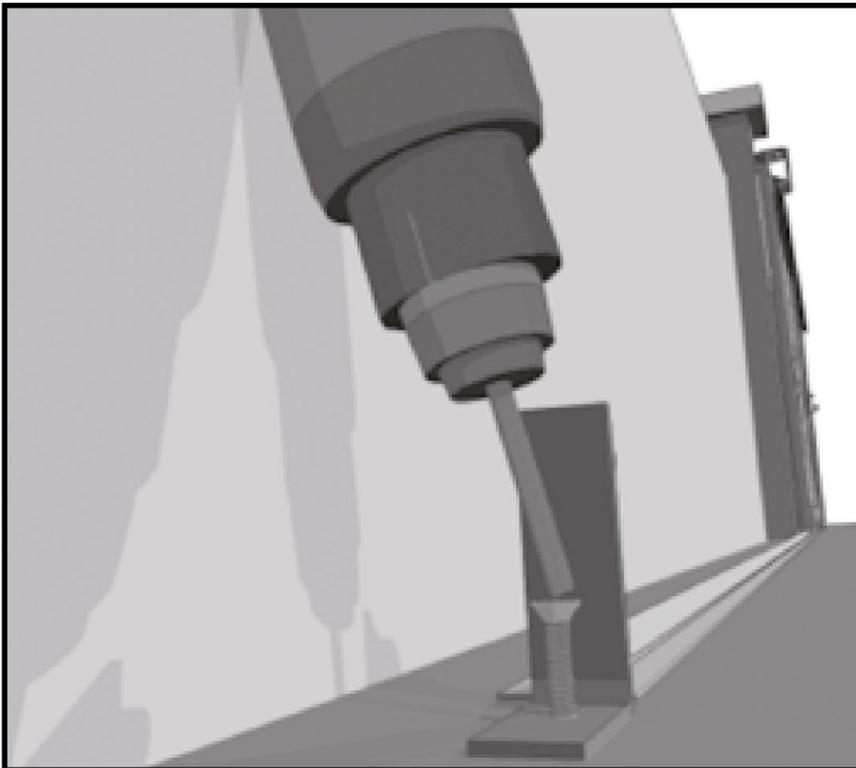
Vérifier la position de la butée pour que le portail ne sorte pas de la platine de guidage.
