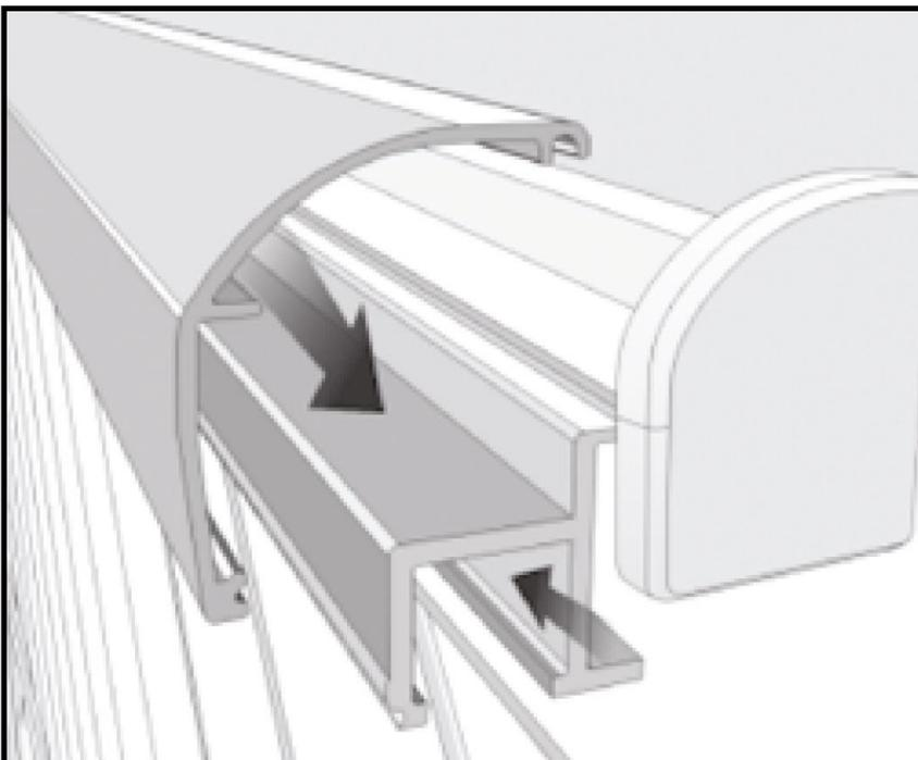
Monter le profilé de clipage pour rail de guidage supérieur, puis mettre ses embouts\*.
