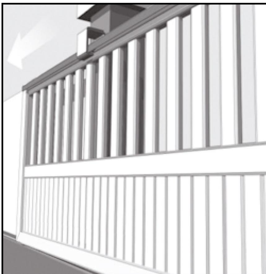
Monter le portail sur le rail inférieur et le faire coulisser par l'intermédiaire du patin de glissement dans le rail de guidage supérieur.
