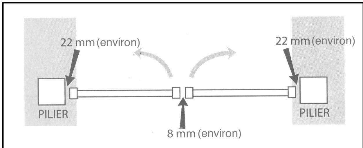
Avant l'installation, vérifier le contenu du kit et les dimensions requises entre les vantaux du portail et les piliers.
