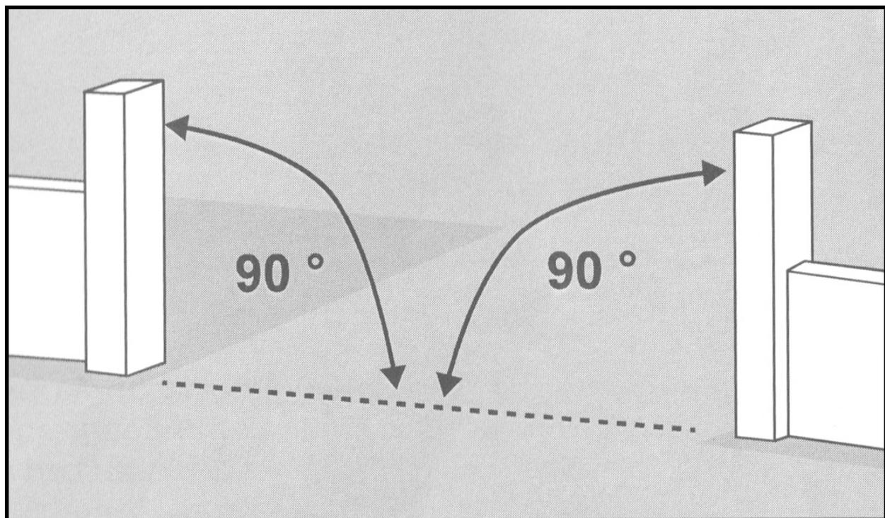
Vérifier l'équerrage et l'aplomb entre les piliers et le sol.
